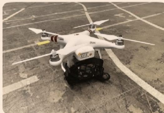
Il drone utilizzato per la sperimentazione, dotato di interfaccia di comunicazione e unità di elaborazione, in grado di fornire servizi in mobilità
